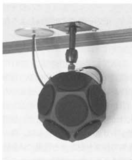
▼<写真 B> ミドル・サブに使っている 12 面体スピーカ
